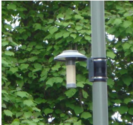
Figuur 2: Diffusiebuisjes houder zoals gebruikt voor de gemeentelijke meetpunten.
