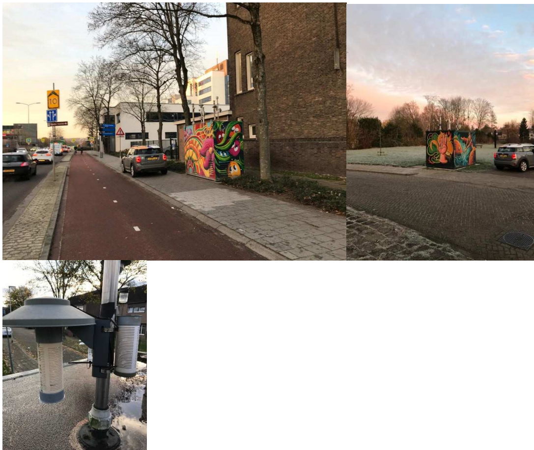
Figuur 6.1.1: diffusiebuisjes in houder bij RIVM-meetstation
